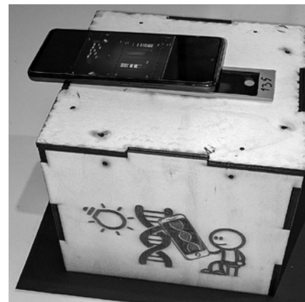
Abbildung 4: Beispiel für ein selbstgebautes Gerät: Cheap-Imager zum Gel-Betrachten Abbildung: Ronja Steiner
