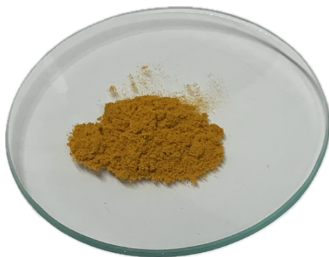
Abb. 5: Das gezeigte pulverisierte Curcumin wurde als Arzneistoff-Surrogat eingesetzt
