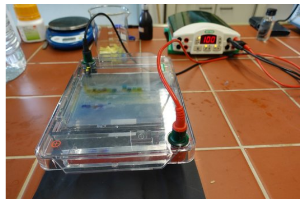
Abb. 14: Gel-Elektrophorese, man erkennt wandernde Farbstoffe im Gel
