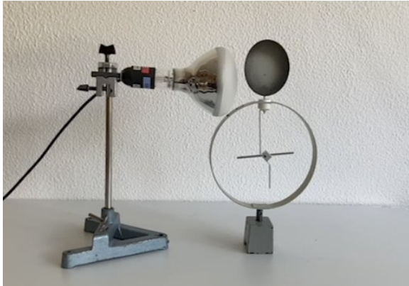
Versuchsaufbau zum Hallwachs-Versuch
