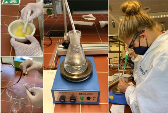
Liberationsversuch; oben links: Herstellung der Pulvermischung, unten links: Trocknen einer Kapsel mit Pressluft, Mitte: Freisetzungsapparatur, rechts: Probenentnahme mit Kolbenhubpipette
