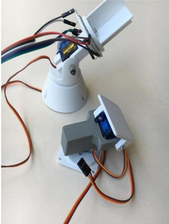
Zwei Minimodelle des Solartrackers
