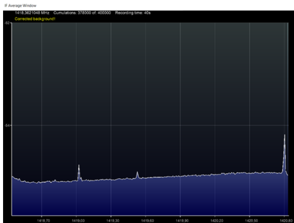
Die Messung mit ausgeschaltetem WLAN. Der Ausschlag links im Bild ist im Vergleich zum vorhergehenden fast verschwunden.
