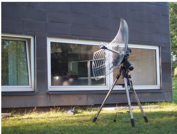
Selbst aufgebaute Parabolantenne
