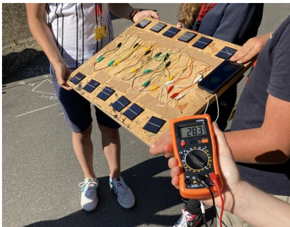
Eines der beiden selbstgebaute Solarmodule lieferte bei senkrechtem Lichteinfall eine Spannung von 28,3 V.
