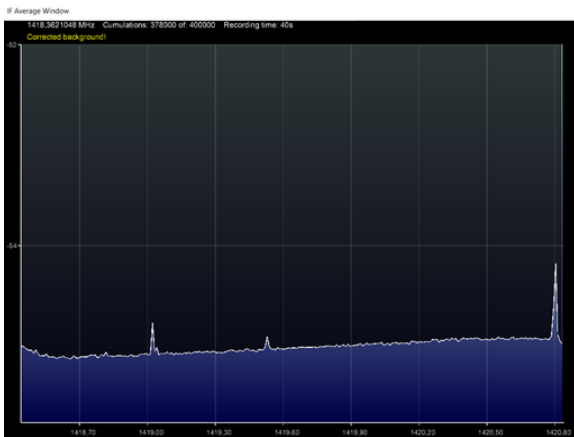
Die Messung mit ausgeschaltetem WLAN. Der Ausschlag links im Bild ist im Vergleich zum vorhergehenden fast verschwunden.
