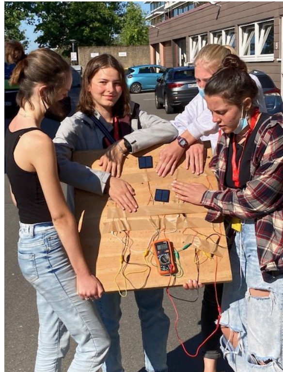
Experiment zum Abdecken einzelner Solarzellen
