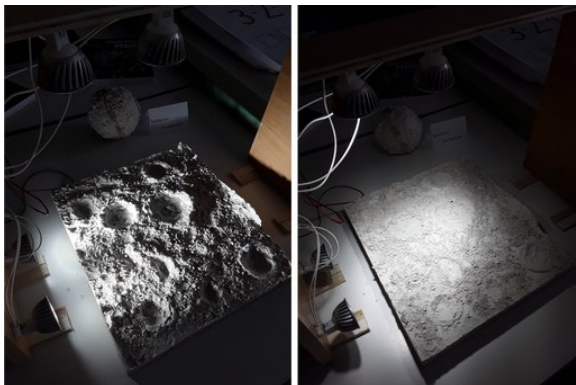
Oberflächenmodell des Mondes zur Simulation der Beleuchtungsverhältnisse bei Halbmond (links) und Vollmond (rechts)
