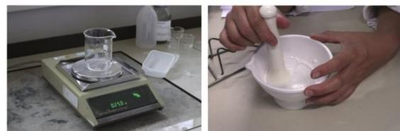
Abbildung 13: Dokumentation über das Wiegen und Anrühren der Formulierungen
