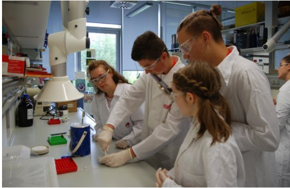
Abbildung 16: Im Labor in Hohenheim: Mörsern mit flüssigem Stickstoff
