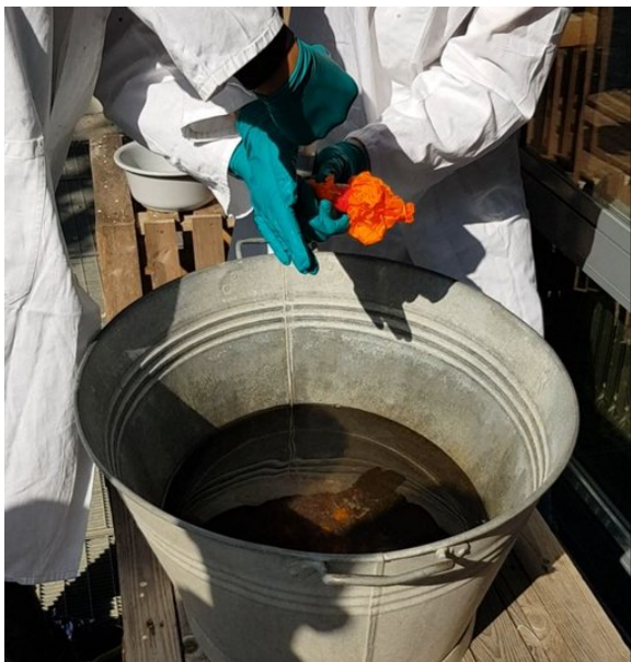
Aufblähetest des Backup Systems im Metallbottich
