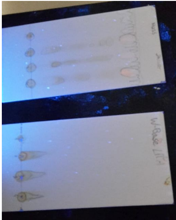
Abbildung 8: Ergebnisse der Dünnschichtchromatographie unter kurzweiligerem UV-Licht.
