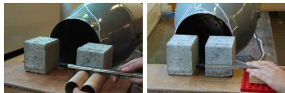
Wir benutzten einen Windkanal, welcher durch die Rotation einer Turbine Luft einsaugt und diese danach beschleunigt. Vor den Windkanal wurden zwei Steine gestellt, um eine Gasse zu simulieren. Wir wollten herausfinden, ob durch die Variation der Abstände unterschiedliche Luftgeschwindigkeiten gemessen werden können.
