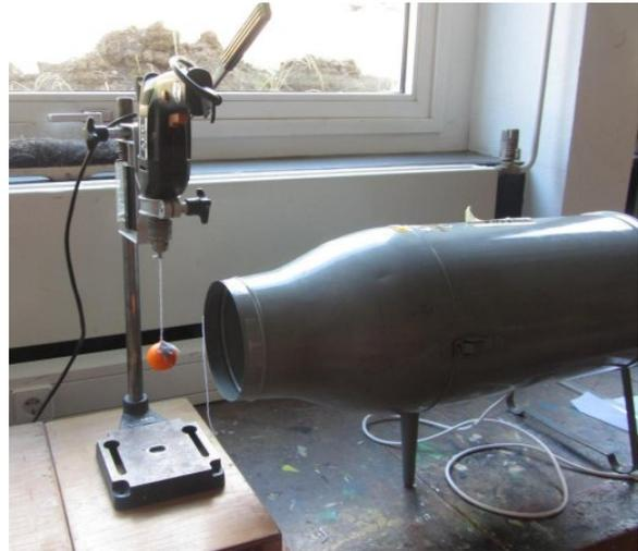
Versuchsaufbau zur Messung der Magnuskraft
