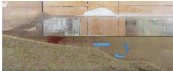
Versuche mit einem Ufer, bei dem der Wirbel die Furche weiter aushöhlt
