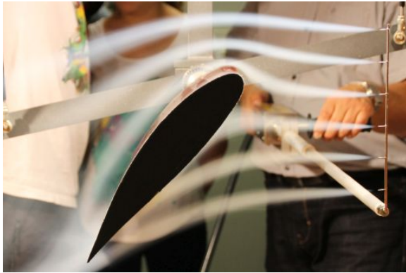
Noch liegt die Strömung am Flügel an
