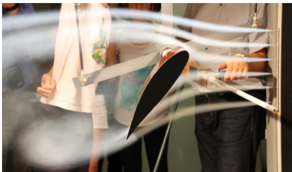
Bei zu steilem Anstellwinkel kommt es zum Strömungsabriss
