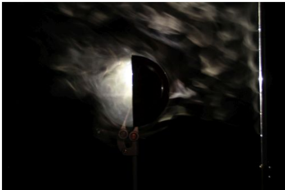
Durch den Unterdruck hinter der hohlen Halbkugel entsteht ein Totwassergebiet in Form einer zweiten Halbkugel
