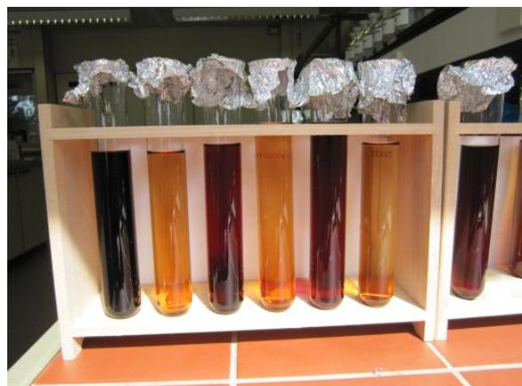
Proben von links nach rechts: p-Aminophenol, Referenz ohne Hydrolyse, Referenz mit Hydrolyse, Probe 2 mit und ohne Hydrolyse, Probe 1 mit und ohne Hydrolyse
