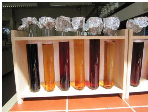
Proben von links nach rechts: p-Aminophenol, Referenz ohne Hydrolyse, Referenz mit Hydrolyse, Probe 2 mit und ohne Hydrolyse, Probe 1 mit und ohne Hydrolyse
