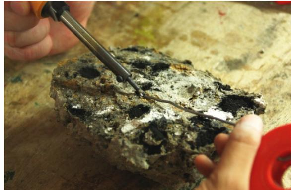
Beim Einlöten der metallischen Einschlüsse in das Schutthaufenmodell.
