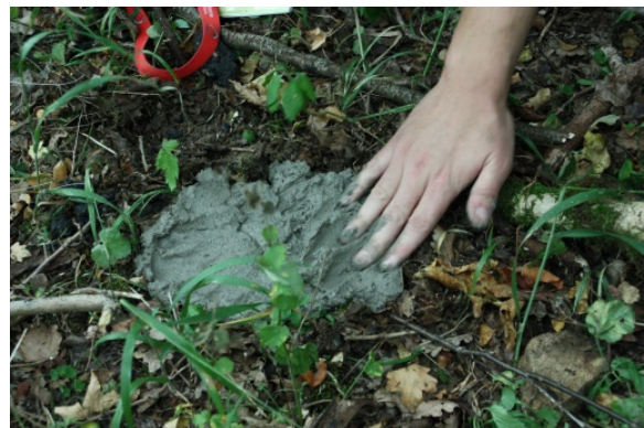
Ausgießen des Kraters mit Blitzzement
