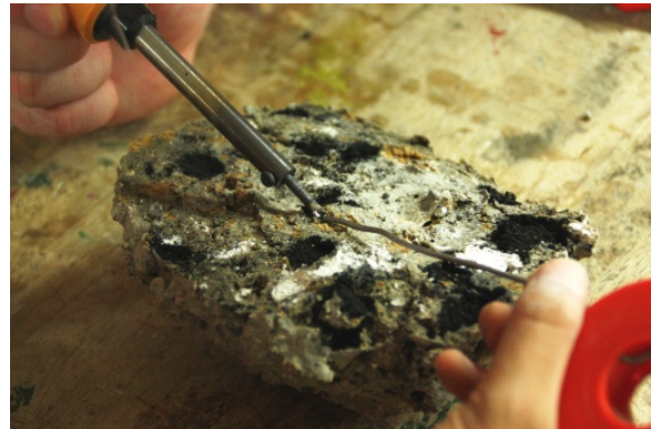
Beim Einlöten der metallischen Einschlüsse in das Schutthaufenmodell.
