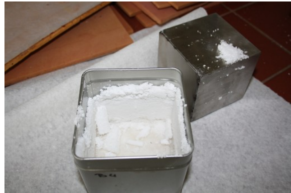
Matsch, Matsch! Natriumcarbonat-Decahydrat-Kiste nach der Beflammung
