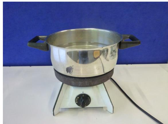
Die Kamera zeigte bei der Herdplatte und beim Wasser sehr hohe Temperaturen an, während sie beim Topf selbst nur Raumtemperatur anzeigte.
