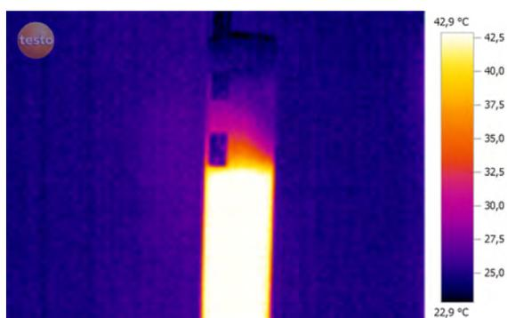
Bei heißem Wasser ist der Füllstand deutlich erkennbar.
