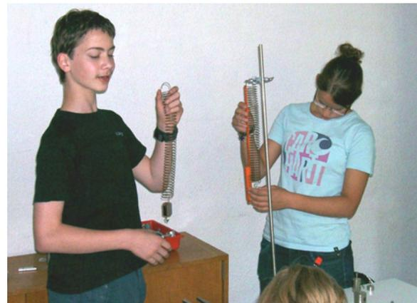
Abbildung 42: Vorversuche zur Kalibration der Federwaage: Bestimmung der Harte verschiedener Schraubenfedern.
