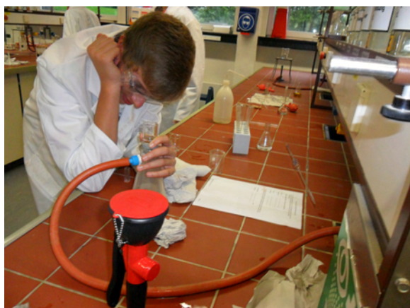
Mit der Nutsche wird der Koffeinperiodidniederschlag von löslichen Verunreinigungen getrennt.
