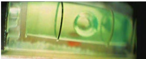
Die Luftblase wird bei Mikrogravitation kugelförmig
