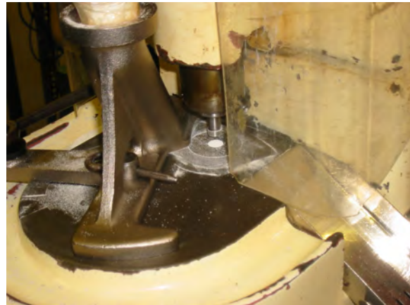
Aufbau einer Füll- und Presseinrichtung einer Exzenterpresse als Schema und als Bild
