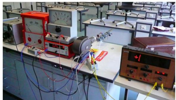
Abbildung 2: Experiment zur Untersuchung der Strahlung einer Glühlampe (Bestandteile: Glühlampe, Dimmer, Thermosäule nach Moll und einen Mikrovoltmeter).
