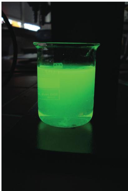
im leicht alkalischen Milieu auftritt. Weil der Verbrauch an Natronlauge proportional zum Volumen an Salzsäure ist, kann man das Volumen an Salzsäure berechnen (in diesem Fall 1:1).
