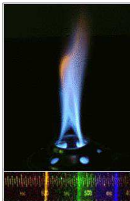
Abb. 40: Diskontinuierliches Spektrum einer Spiritusflamme. Man sieht deutlich die Spektrallinien bei gelb, grün und blau. Die glühenden Festkörperteilchen in der Flamme erzeugen ein schwach sichtbares zusätzliches Kontinuum.
