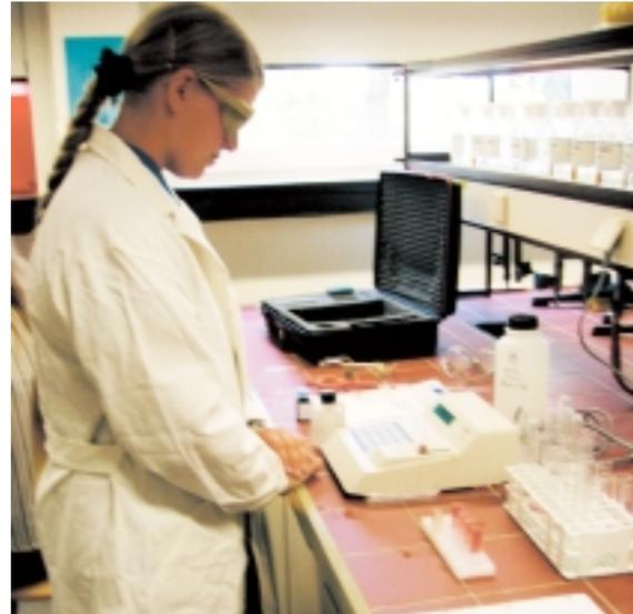
Photometrische Bestimmung des Nitratgehaltes einer Wasserprobe
