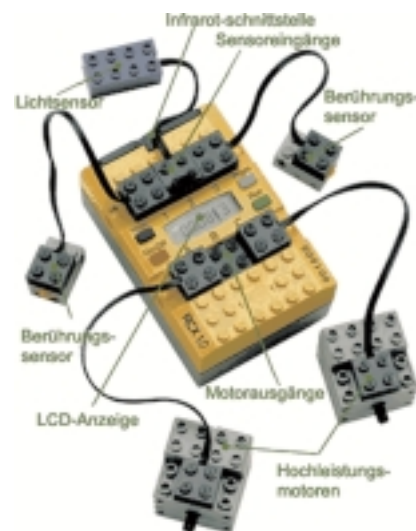
Bild 3: Der RCX und seine Ein/Ausgänge
