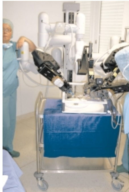
Bild 4: Der manuell gesteuerte Manipulator des „da Vinci“
